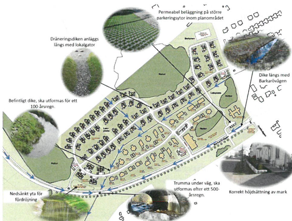
Förslag till systemlösning (Sweco dagvattenutredning)
